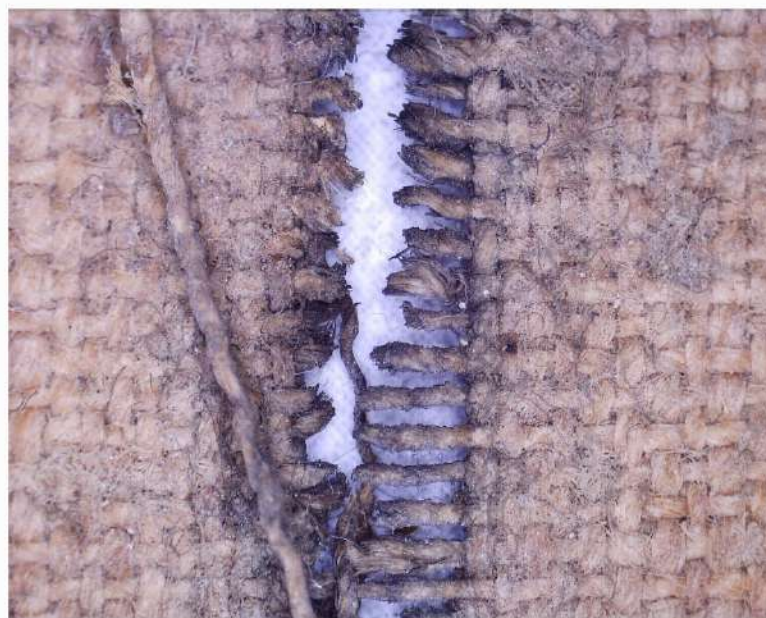
Indagini microscopio digitale, dettaglio bruciatura di candela
